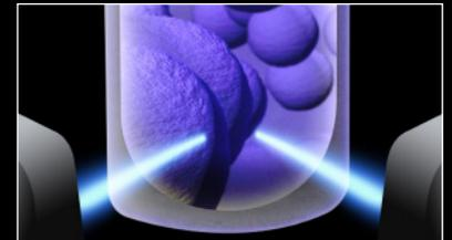
Leitura de Fluorescência: configuração radial da fonte de luz e detectores que otimizam a excitação do fluoróforo e sua consequente detecção.
