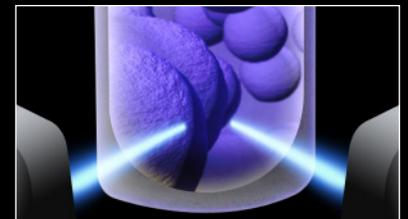
Leitura de Fluorescência: configuração radial da fonte de luz e detectores que otimizam a excitação do fluoróforo e sua consequente detecção.
