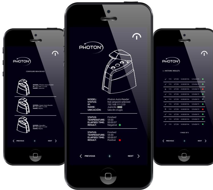
Ambas auto-lectoras pueden conectarse a cualquier dispositivo móvil (ej.: teléfono inteligente) vía Bluetooth o conexión Wi-Fi. Esto permite el uso de la aplicación Bionova® Wireless Assistant. Se trata de una aplicación simple que está diseñada, básicamente, para generar tickets virtuales que pueden imprimirse o compartirse de una manera muy simple. En general, esta aplicación permite:
