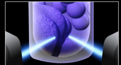
Lectura fluorescente: configuración radial de la fuente de luz y los detectores que optimizan la excitación del fluorocromo y su subsiguiente detección.
