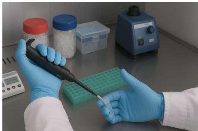
Finalmente, la solución etanol:agua 40:60 en lugar de agua al 100% se utiliza ya que el etanol ayuda a disminuir levemente la polaridad del medio, facilitando la elución de las esporas desde los portadores.
