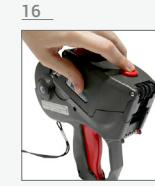
Press the button to open the cover | Presione el botón para abrir la cubierta | Pressione o botão superior para abrir.
