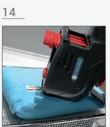
Slide the labeler back until you see the entire label stuck on the surface of the load | Deslice la etiquetadora hasta que toda la etiqueta quede pegada en la carga | Deslize a rotuladora de forma a que a etiqueta seja fixada na carga.
