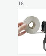
Place the roll at the same level of the gray cylinder and cut the tape close to the cylinder | Coloque el rollo a la altura del cilindro gris y corte la cinta en un lugar cercano a este | Coloque o rolo na altura do cilindro cinza e corte a fita perto do cilindro.
