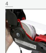
Place the label roll between the fasteners | Coloque el rollo de etiquetas entre los sujetadores | Coloque o rolo de etiqueta entre os fixadores.
