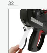
Press the labeler trigger while the liner residue is removed in order to achieve a total clearance of the label | Presione el gatillo de la etiquetadora en el momento que va a retirar el remanente de liner atascado para así logar un total despeje del mismo | Pressione o gatilho na rotuladora no momento de retirada do liner atulado até total remoção.
