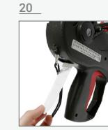
Remove the liner remnant by sliding it in the opposite direction of the labeler | Retire el remanente de liner deslizándolo en dirección opuesta da etiquetadora | Remova o remanescente deslizando-o na direção oposta da etiquetadora.
