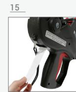
The empty liner should emerge from the back output of the labeler | El liner vacío irá saliendo por la ranura ubicada en la parte posterior de la etiquetadora | O liner vazio vai sair através da ranhura na parte de trás da rotuladora.
