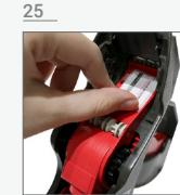
Remove any loose labels on the inside of the labeler and under the supply bar | Retire las etiquetas sueltas que quedan en el interior de la etiquetadora y bajo la barra de suministro | Remova todas as etiquetas soltas que estejam dentro da rotuladora e sob a barra de alimentação.
