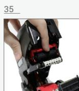
Press down on the center portion of the ink roller fastener until the roller is released and can be removed | Presione el dispositivo de fijación del rodillo de tinta hasta que el rodillo se suelte y pueda ser removido | Pressione o dispositivo de bloqueio do rolo de tinta até que o rolo seja solto e possa ser removido.
