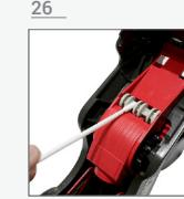
Rub a swab with solvent onto surfaces and bearings where adhesive remnants are observed | Con ayuda de un hisopo y disolvente, límpie la superficie y rodamientos en los que se observe resto de adhesivo | Com a ajuda de um cotone e solvente, limpe a superfície e os roldamentos onde se observem restos de adesivo.
