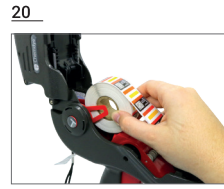
20 Remove the roll from the fasteners by moving the roll upward | Saque el rollo de etiquetas de entre los sujetadores desplazando el rollo hacia arriba.
