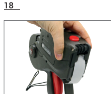
16 Remove any loose labels on the inside of the labeler and under the supply bar | Retire las etiquetas sueltas que queden en el interior de la etiquetadora y bajo la barra de suministro.
