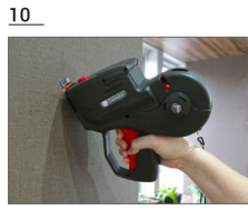
10 Slide the labeler back until you see the entire label stuck on the surface of the load | Deslice la etiquetadora hasta que toda la etiqueta quede pegada en la carga.
