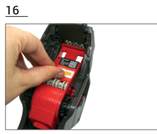
16 Remove any loose labels on the inside of the labeler and under the supply bar | Retire las etiquetas sueltas que queden en el interior de la etiquetadora y bajo la barra de suministro.
