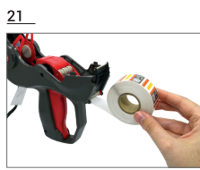
21 Place the roll at the same level of the gray cylinder and cut the tape close to the cylinder | Coloque el rollo a la altura del cilindro gris y corte la cinta en un lugar cercano a este.
