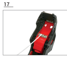
17 Rub a swab with solvent onto surfaces and bearings where adhesive remnants are observed | Con ayuda de un hisopo y disolvente, limpie la superficie y rodamientos en los que se observe resto de adhesivo.
