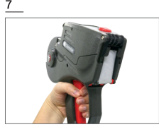
7 Pull and release the trigger several times until the liner is stretched out. The end of the liner should emerge from the back output | Presione y suelte el gatillo varias veces hasta lograr tensionar el liner. El extremo del liner deberá emerger por la ranura de salida.
