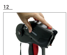
12 Press the button to open the cover | Presione el botón para abrir la cubierta.
