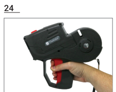
24 If remnants persists inside the labeler, shake it (pressing and releasing the trigger) until the remnants falls | Si persisten restos de liner dentro de la etiquetadora, sacuda y soltando el gatillo hasta que los restos caigan.
