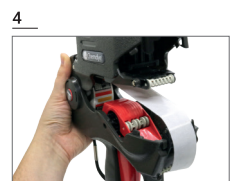
4 Center the liner over the supply bar | Centre el liner sobre la barra de suministro.
