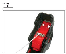
17 Rub a swab with solvent onto surfaces and bearings where adhesive remnants are observed | Con ayuda de un hisopo y disolvente, limpie la superficie y rodamientos en los que se observe resto de adhesivo.
