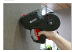
9 Put down the label on the labeling load | Apoye la etiqueta expuesta sobre la carga a etiquetar.
