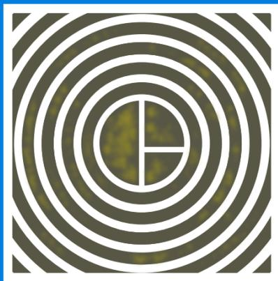
Vapor sobrecalentado o gases no condensables
